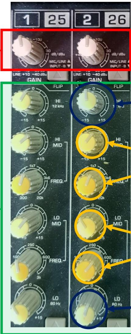
Action sur une fréquence fixe 12 KHz aigu
